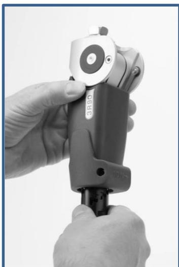
伸展補助バネの調整は、膝継手下部のプラスチック部分を回転させることで、5段階に調整できます。
