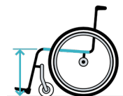
vSH= cm Vordere Sitzhöhe Boden – Oberkante Sitzbespannung
