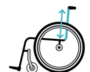
RH= cm Rückenhöhe Oberkante Sitzrohr – Oberkante Rückenbespannung
