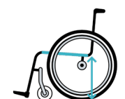
hSH= cm Hintere Sitzhöhe Boden – Oberkante Sitzbespannung
