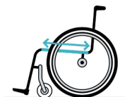
ST= cm Sitztiefe Vorderkante Sitzbespannung – Rückenrohr
