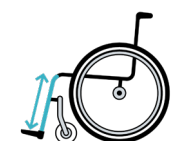
UL= cm Unterschenkellänge Oberkante Sitzbespannung – Oberkante Fussplatte (Mitte)
