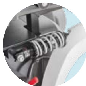
EF001 Amortisseurs roues directionnelles
