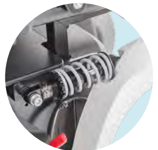
EF001 Lenkradschwinge, gefedert
