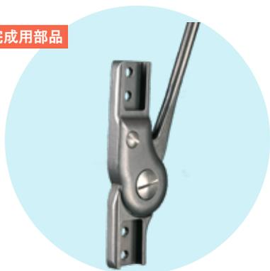
操作性と膝の安定性を考えたステンレス製のベールロック式膝継手です。完全伸展で自動的にロックがかかり、ロングレバーでの手動解除が可能です。ロングレバーは曲げ加工によりスイスロック式として使用します。
