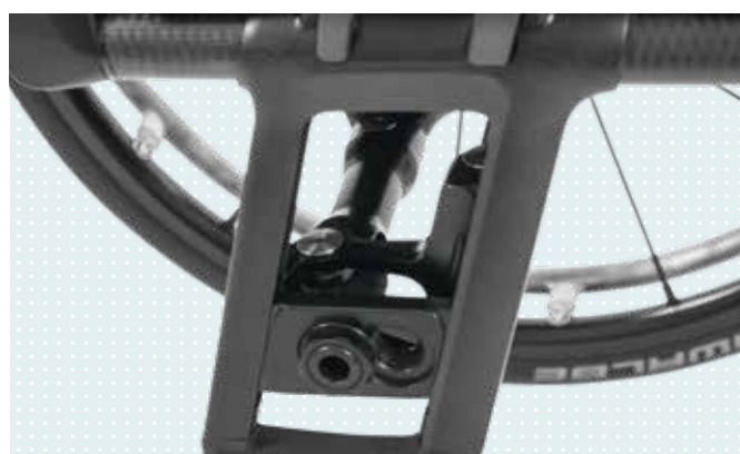
☛ Výška sedadla a ťažisko Zenitu sú nastaviteľné pomocou adaptéra zadného kolesa
