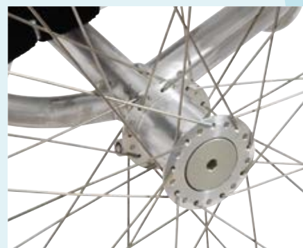
Die Oversize Achse bietet mit 25 mm Durchmesser enorme Stabilität und Langlebigkeit.
