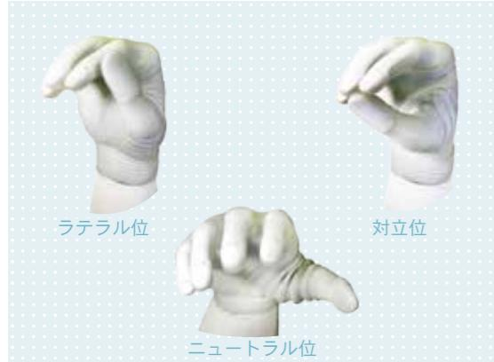
ミケランジェロハンドは、開閉動作のためのメイン駆動装置と、独立して動く拇指駆動装置を内蔵しています。拇指の位置が切替わる事で、ラテラル位での把持を可能にしました。
