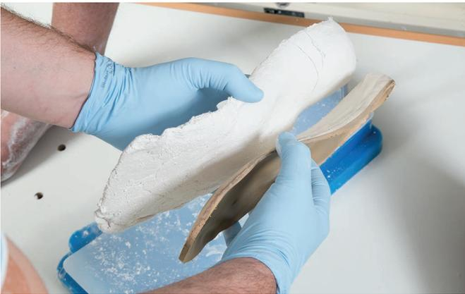
ソールの長さを決定し、石膏インソールをカットします。
