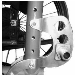
MG86 車軸延長プレート
