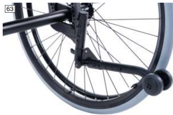
Anti-bascule désactivé en position supérieure
