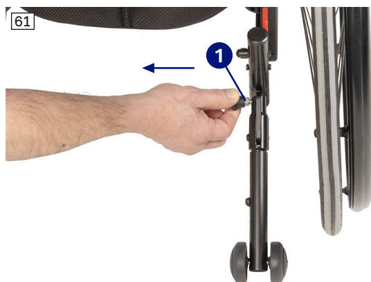
Anti-bascule activé en position inférieure
