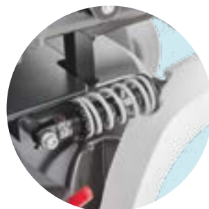
EF001 Amortisseurs roues directionnelles
