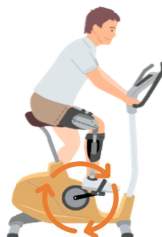
最低2回転ペダルを漕ぐことで油圧抵抗が下がり軽くペダルを漕ぐことができる
