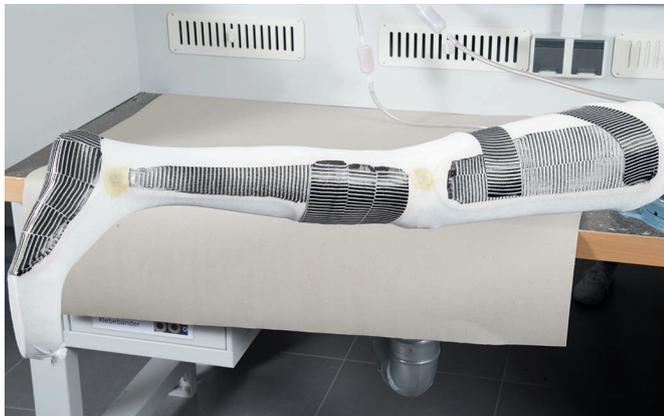
カーボンファイバークラス帯ひも(616H11)を使用し、支柱や半月が配置されている装具の耐荷重部分を補強します。
