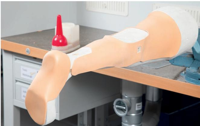
真空成型された内張りをカットし、陽性モデルに接着します。
