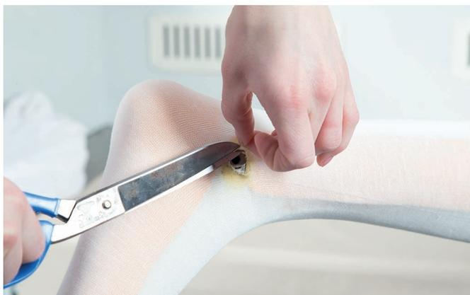
ペルロンストッキネット(623T3)を1層、陽性モデルにかぶせます。アライメントアダプター上のペルロンストッキネットに接着剤を塗布し、接着剤を乾燥させます。
