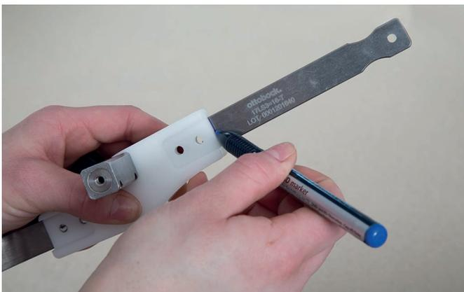
使用する支柱をすべてダミー(または継手)に取り付け、支柱に継手固定部をマークします。
