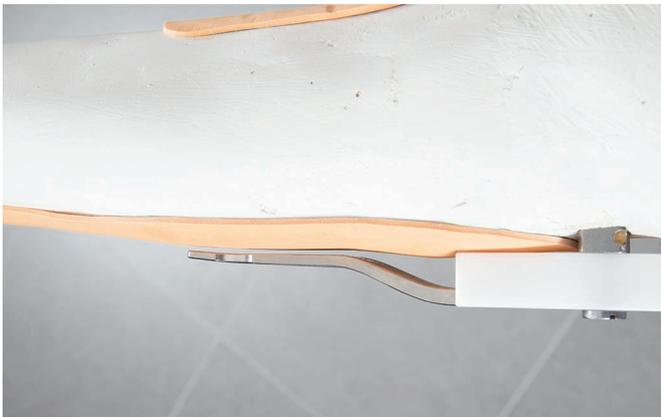
陽性モデルと支柱、あぶみの距離を確認します。ラミネーション時に樹脂を確実に浸み込ませるために、約2mm離す必要があります。
