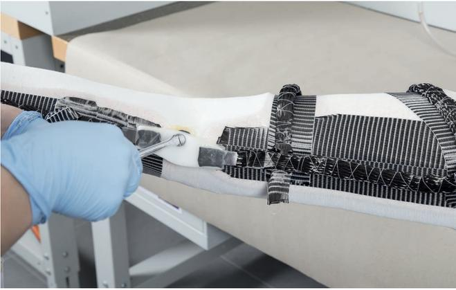
支柱、半月、継手ダミーもしくは継手を陽性モデルにセットします。
