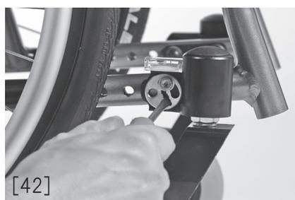
調整が終了したら、①フレーム外側のボルト、②フレーム内側のボルト、の順で締め直します。
