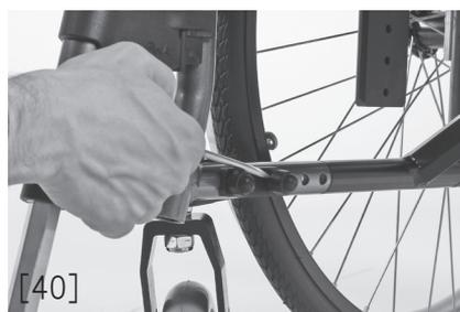
フレーム内側のボルト 2 本のうち、後ろ側のボルトを緩めます。
