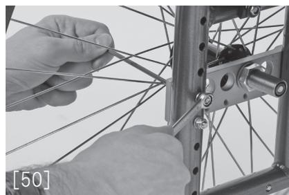
バックサポートパイプを上下させ、希望の高さで再度ボルトを取付けます。
