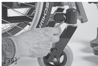
フレーム内側のボルトキャップ（2箇所あるうちの後ろ側）を、ドライバーなどで取外します。
