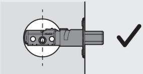
Si les trous de verrouillage ne sont PAS centrés, ajustez le verrou. Voir Ajustement de verrou.
