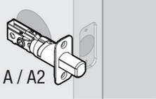
**B** Si les trous de verrouillage sont centrés dans le trou de la porte, aucun ajustement n'est nécessaire. Passez à l'étape 4.
