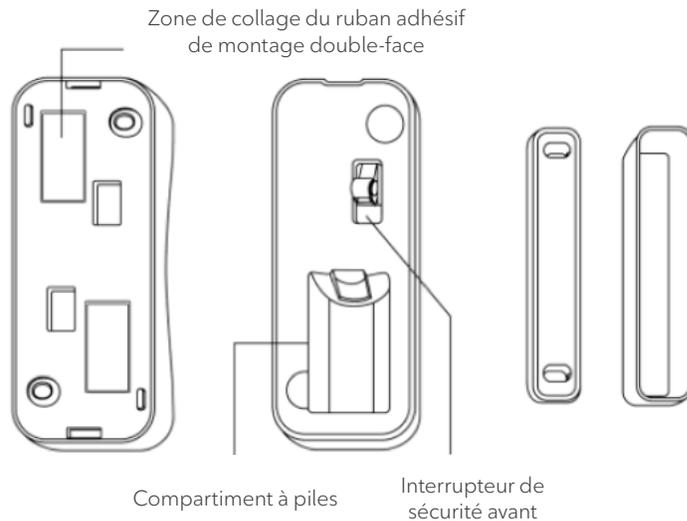
Pour fixer le détecteur à un mur, à une porte ou à un cadre de fenêtre, utilisez du ruban adhésif double-face :
