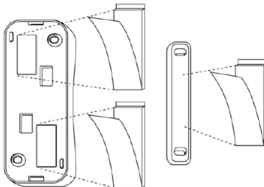
4. N'installez pas le détecteur directement sur un cadre de métal ou à proximité, ni sur d'autres objets métalliques; cela pourrait affaiblir le signal radio transmis.
