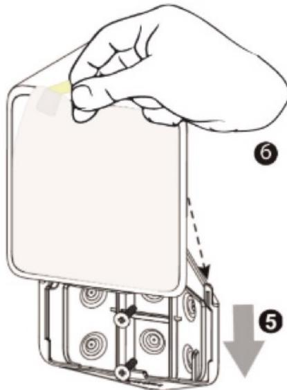
4. Installer le détecteur sur le support en le faisant glisser vers le bas jusqu'à ce qu'un clic se fasse entendre.
