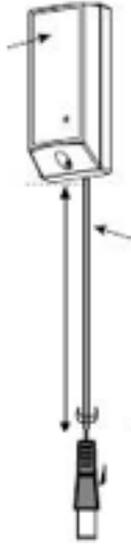
2. Fixez le détecteur de fuite d'eau et son câble au mur à l'aide des trois attaches-fils. Un attache-fil doit être fixé immédiatement au-dessus du détecteur de fuite d'eau. Le détecteur de fuite d'eau doit être installé seulement en position verticale, face vers le bas. Les deux autres attaches-fils peuvent être utilisés au besoin.
