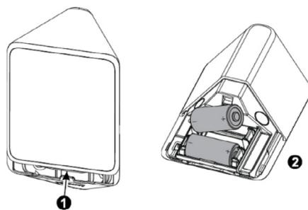
1. Séparer le détecteur du support de montage et retirer les deux piles.
