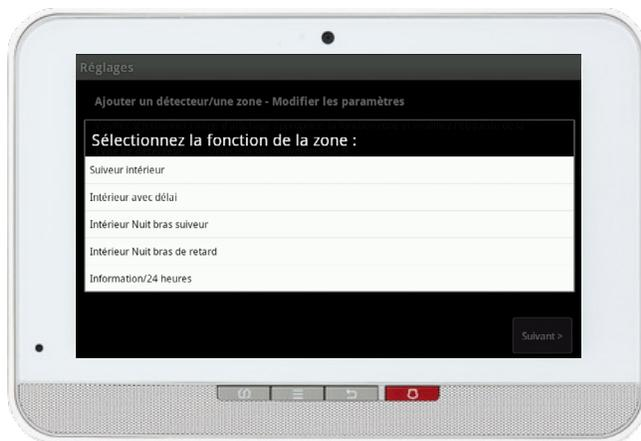
15. Les fonctions relatives aux zones pour le détecteur de mouvements sont indiquées à gauche. À cet écran, une fonction doit être sélectionnée pour fermer la fenêtre contextuelle.
