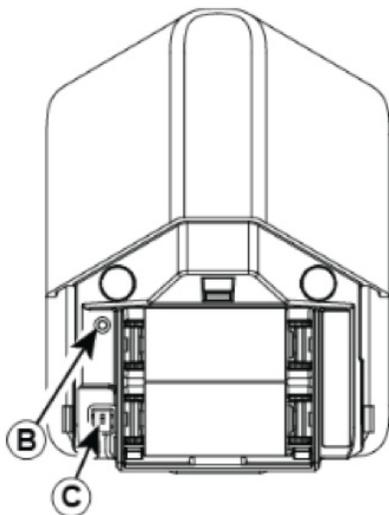
3. Insérer une des deux piles dans le détecteur en étant attentif à sa polarité.
