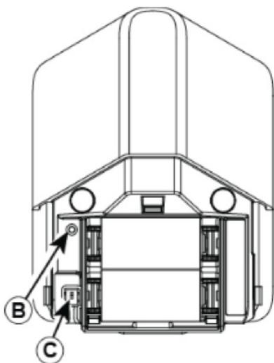
1. Séparer le détecteur du support de montage et retirer les deux piles.
