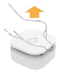
6. Retirez le couvercle du compartiment à pile de l'appareil, comme l'indique l'image à gauche.
