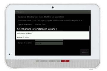
Les fonctions relatives aux zones pour le détecteur de fuites d'eau sont indiquées à gauche. À cet écran, une fonction doit être sélectionnée pour fermer la fenêtre contextuelle.
