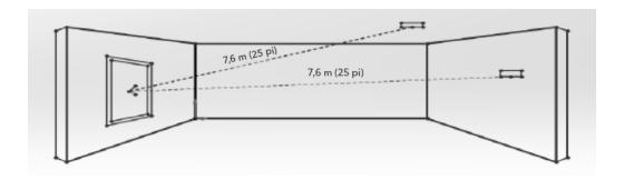
L'angle entre une ligne perpendiculaire à la vitre et une ligne entre la vitre et le détecteur a une incidence sur la sensibilité du détecteur. Plus l'angle est prononcé, moins la sensibilité du détecteur sera bonne.
