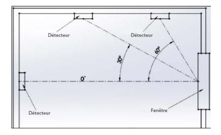
**Remarque :** La distance maximale est de 7,6 m (25 pi) si la taille de la vitre est d'au moins 40 cm x 40 cm (15¾ po x 15¾ po). La distance minimale est de 6 m (20 pi) si la taille de la vitre est entre 30 cm x 30 cm (12 pi x 12 pi) et  $40 \text{ cm} \times 40 \text{ cm} (15¾ po x 15¾ po)$ .
