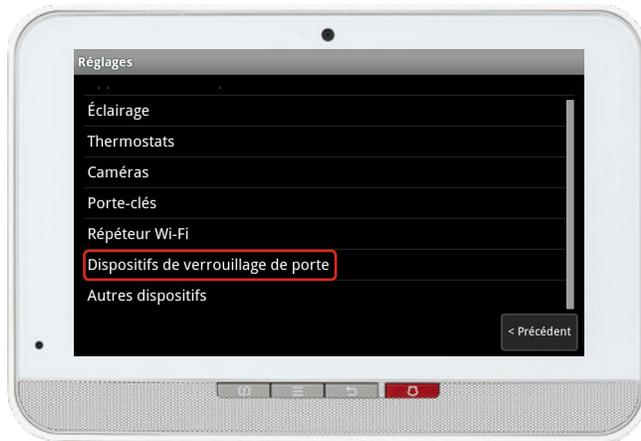
6. À l'écran **Dispositifs de verrouillage de porte**, appuyez sur **Suivant**. Le système prendra jusqu'à 30 secondes pour trouver la serrure intelligente.
