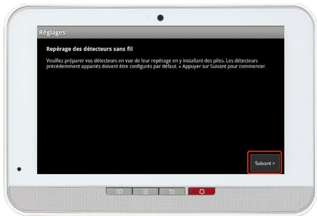
7. Cliquez **Suivant** sur l'écran **Localisation des détecteurs sans fil**. L'écran tactile va alors rechercher un détecteur pendant une durée maximale de 10 minutes.
