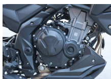
Motor de 2 cilindros, 46,2HP a 8500rpm.
