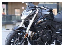
KYB Suspensión Telescópica invertida KAYABA
