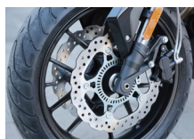
NISIN Frenos doble disco flotante con ABS BOSCH
