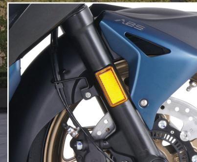
Horquilla telescópica de  $\text{Ø}37\text{mm}$  con doble tija, y 109,4mm de recorrido y doble amortiguador regulable de 98mm de recorrido.
