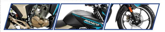
Motor: Monocilíndrico, OHC, 4 tiempos, Enfriado por aire,
