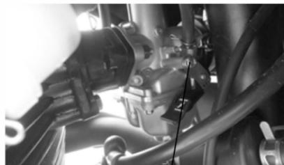
Tornillo de ajuste de la velocidad de ralenti
