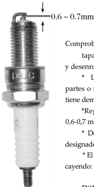
Comprobación de la bujía (Retire la tapa de la bujía y desenrosca la bujía .
