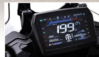
Tablero DIGITAL TFT de 7" con conectividad BLUETOOTH y sistema de navegación básica.
