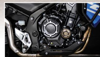
Embrague antirebote, multidisco en baño de aceite y control de tracción desconectable
