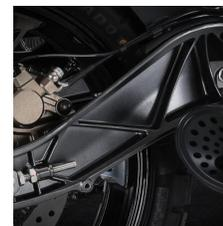
**Basculante en fundición de aluminio con forma arqueada para la salida del escape.**
