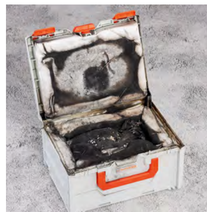
Erfolgreicher Brandversuch: die CEMO Brandschutzbox hält.
