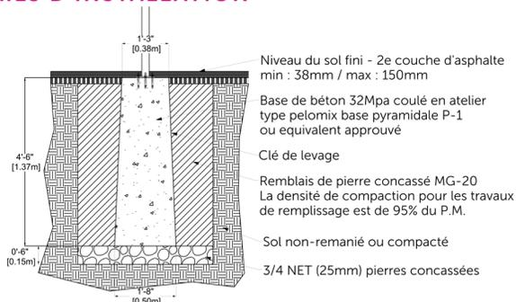
La base doit être au niveau approximatif de la première couche d'asphalte. Toutes les bases d'un même produit doivent être AU MÊME NIVEAU.
