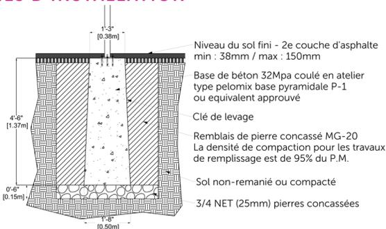
La base doit être au niveau approximatif de la première couche d'asphalte. Toutes les bases d'un même produit doivent être AU MÊME NIVEAU.
