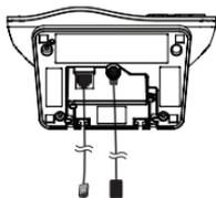
2. Achemenez le fil téléphonique à travers le trou rectangulaire du support d'installation murale et branchez-le dans la prise téléphonique. Achemenez le fil du cordon d'alimentation du socle et branchez-le dans une prise de courant qui n'est pas contrôlée par un interrupteur.
