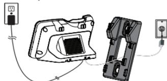
3. Placez les encoches du bas du socle contre les languettes du bas de la plaque de fixation (indiqué par un B). Assurez-vous que les encoches du haut du socle se trouvent au-dessus des languettes du haut de la plaque de fixation (indiqué par un A) Appuyez sur le téléphone vers le bas, jusqu'à ce qu'il se verrouille en place.
