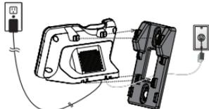
4. Alignez les trous du support avec la plaque et glissez le support jusqu'à ce qu'il se verrouille en place. Enroulez le fil téléphonique et le cordon d'alimentation et attachez-les avec une attache torsadée.
