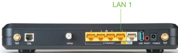
1. Pour faciliter la configuration avancée sans fil de votre appareil, il est fortement recommandé de brancher l'ordinateur dans le connecteur **LAN 1** à l'arrière du modem-routeur.
