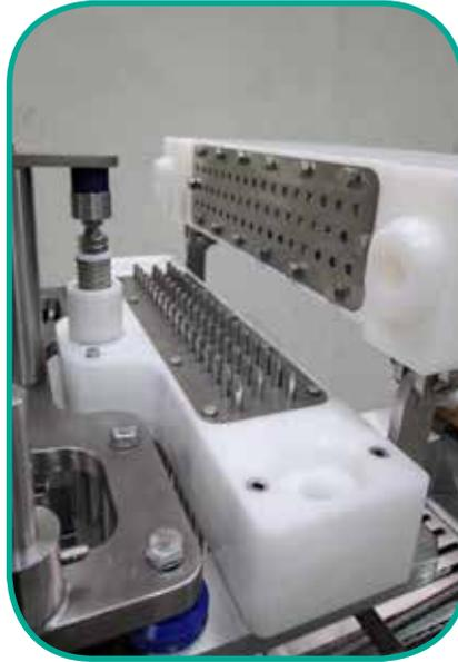
Der Druck der pneumatisch einzeln gefederten Nadeln kann stufenlos eingestellt werden. Alle Nadeln können zur Reinigung leicht und ohne Werkzeug entnommen werden. Wir bieten verschiedenste Nadeltypen in 4, 3 oder 2,5mm an, um den unterschiedlichen Produktanforderungen gerecht zu werden.
