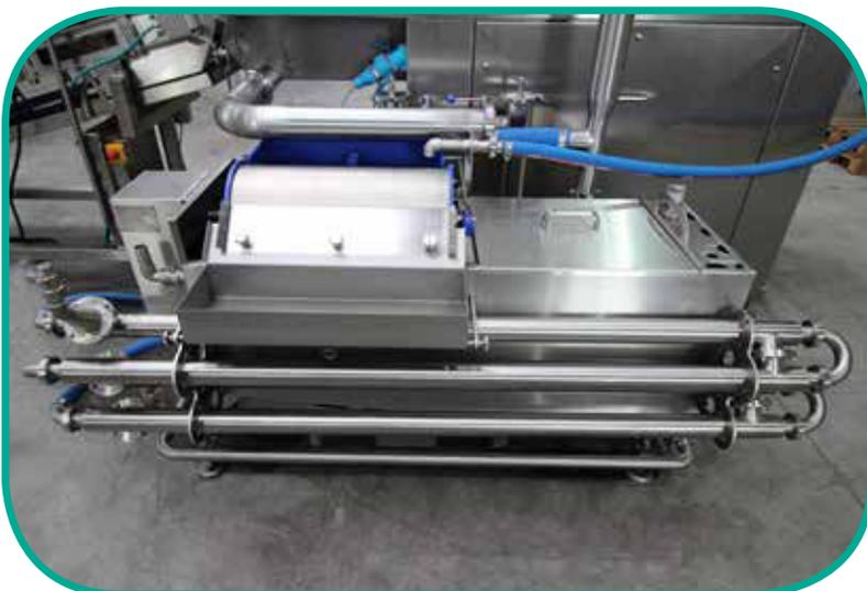
Um die Lake konstant frei von Partikeln zu halten, kann jeder Injektor mit einem automatischen Lakebecken ausgestattet werden, welches die Lake durch einen Rotationsfilter reinigt und die Partikel abführt. Zur Beruhigung der Lake wird das Becken in zwei Zonen eingeteilt. Zusätzlich kann noch ein Inlinefilter verwendet werden.
