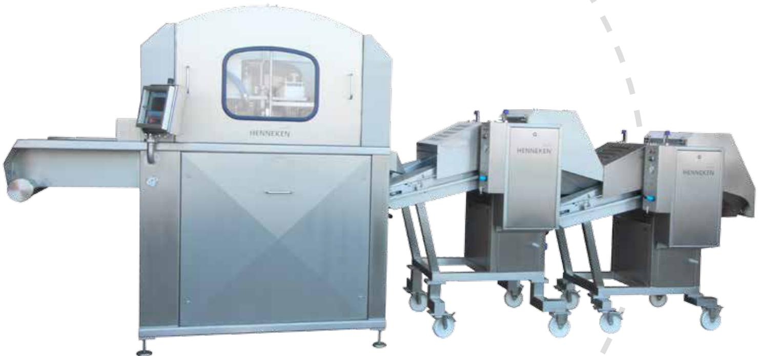
Bei den Injektoren HPI 450 und HPI 650 besteht die Möglichkeit den Injektor mit einem Doppelkopf auszurüsten. Die maximale Nadelanzahl beim HPI 450 liegt somit bei 336 und beim HPI 650 bei 486 Nadeln. Hierbei handelt es sich selbstverständlich um Einzelnadeln. Bei Henneken gibt es keinen Einsatz von Doppel- oder Mehrfachnadeln, da diese Lakenester bei Knochenkontakt verursachen.
