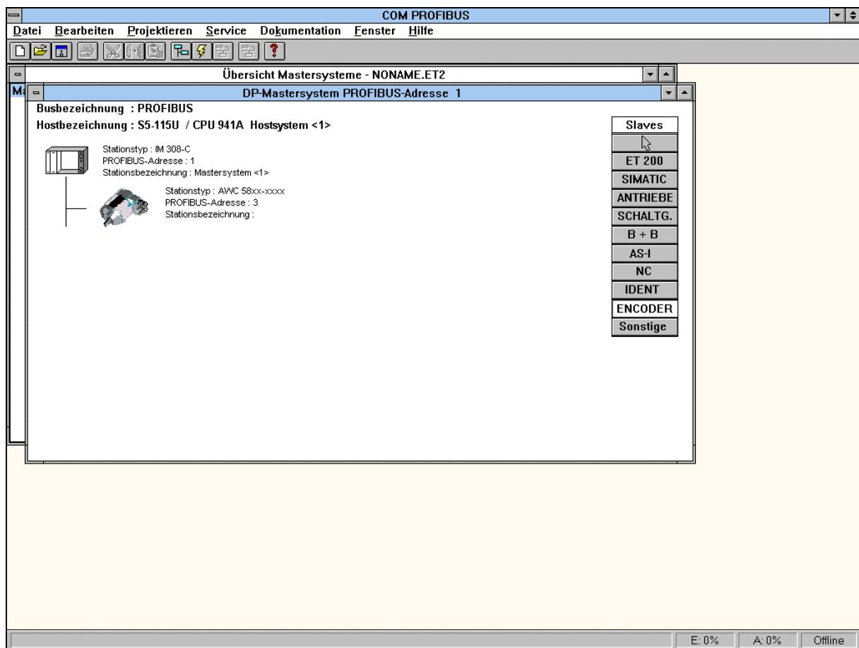
In den Slaveparametern wird mit dem Button Konfigurieren die gewünschte Konfiguration des Encoders ausgewählt:
