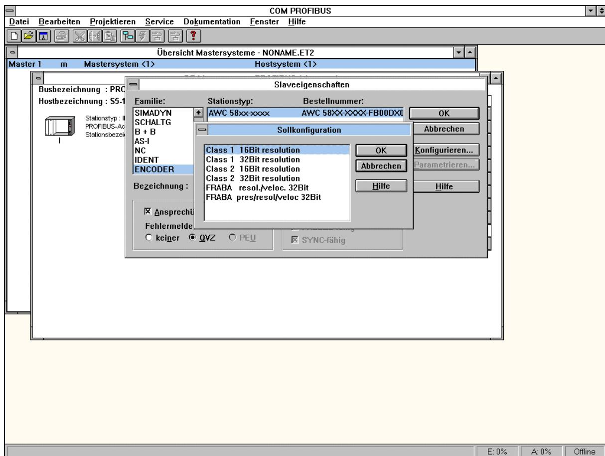
Hierbei kann aus den oben genannten sechs Konfigurationen gewählt werden. In der darauffolgenden Maske wird die Anzahl der zu belegenden Ein- und Ausgangsworte entsprechend der gewählten Konfiguration eingetragen.
