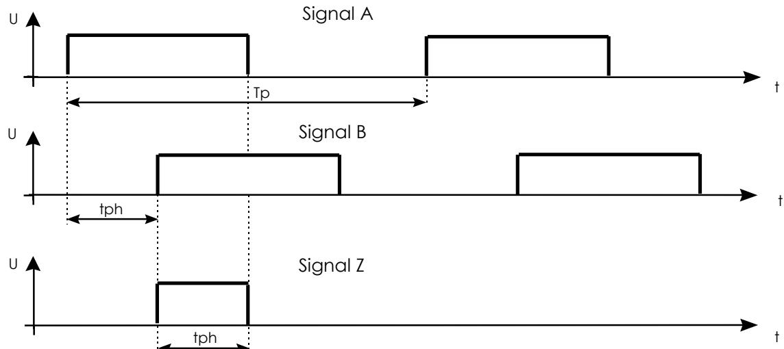
Signal A : Rechtecksignal Kanal A, Inkrementmarke
