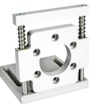
einem Messrad mit einem Umfang von 305 oder 500 mm ermöglicht eine optimale Positionierung des Encoders über dem Förderband oder dem gemessenen Material. Die präzise abgestimmte Federung garantiert einen gleichmäßigen Druck des Messrades auf das Objekt. Die Doppelfederkonstruktion übt einen senkrechten und gleichen Druck auf das zu messende Material aus. Dies gewährleistet eine genaue Messung bei Anwendungen, bei denen das Material in beide Richtungen fließt.
