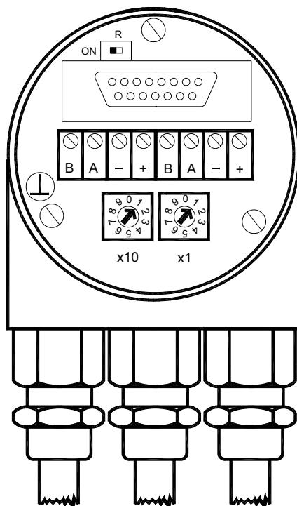
Die Einstellung der Profibus-Teilnehmeradresse erfolgt über die beiden Drehschalter in der Anschlusshaube. Mögliche (erlaubte) Adressen liegen zwischen 1 und 99, wobei jede nur einmal vorkommen darf. Die Anschlusshaube kann einfach durch Lösen von zwei Schrauben am Winkelcodierer zur Installation abgenommen werden.
