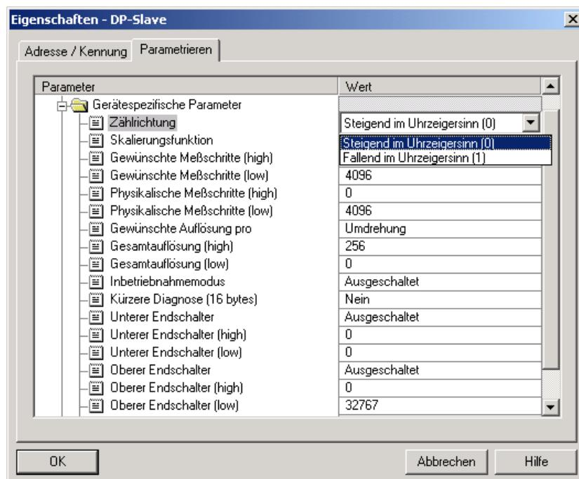
Bedingt durch die Projektierungssoftware STEP 7 werden 32-Bit-Parameterwerte (z.B. Gesamtauflösung, Endschalter, etc.) in High- und Low-Word aufgeteilt.
