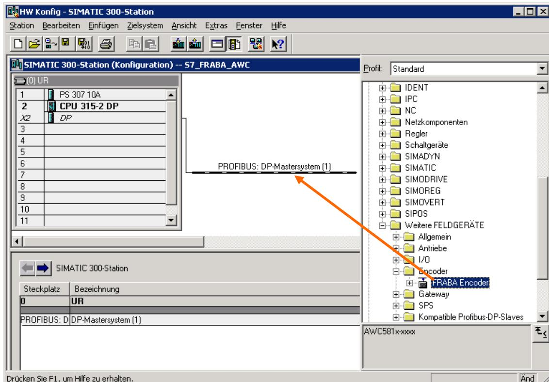
Nachdem über den Menüpunkt „Einfügen“ – „Mastersystem“ das Profibus-Netz im Hardwarekonfigurator projektiert wurde, kann der Absolutwertgeber aus dem Hardwarekatalog ausgewählt und in das Netz eingefügt werden. Hierzu wird das Gerät „FRABA Encoder“ per Drag&Drop an den Bus angeschlossen (oder Doppelklick auf das Modul bei markiertem Bus).
