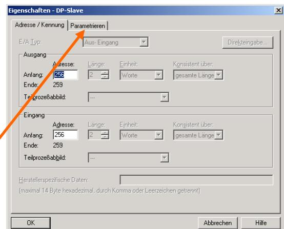
Hier werden nun die Parameter des Gerätes eingegeben. Nach Anwahl des Ordners „Gerätespezifische Parameter“ können – je nach gewählter Encoderklasse – unterschiedliche Parameter eingegeben werden. Besteht in den Feldern rechts die Auswahl zwischen mehreren Möglichkeiten, öffnet
