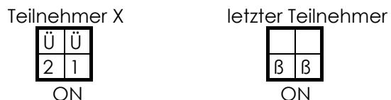
Die Einstellung der Knotennummer erfolgt über 5 DIP-Schalter in der Anschlußhaube. Die Anschlußhaube kann einfach vom Endanwender durch Lösen von zwei Schrauben am Winkelcodierer zur Installation entfernt werden. In folgendem Beispiel wurde die Teilnehmeradresse 13 (dezimal) eingestellt:
