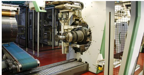
**Máquina de Montagem de Pneus**
