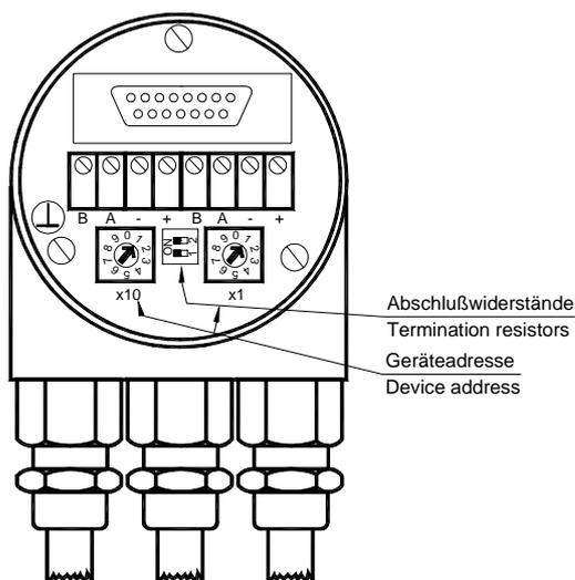
In der Anschlußhaube sind Widerstände vorgesehen, die bei Bedarf als Leitungs-Abschluß zugeschaltet werden können.
