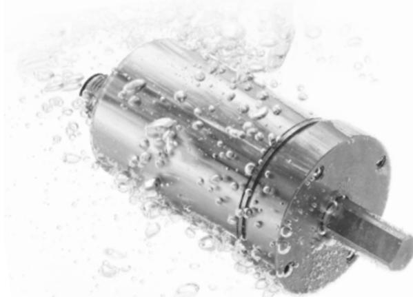
IXARC系列旋转编码器可提供高达IP69K的防护等级。有不锈钢外壳和法兰可供选择,可保护编码器免受气体和灰尘的腐蚀。重载型编码器可承受高达300N的轴负载和300g的抗震能力。
