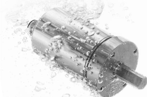
IXARCロータリーエンコーダは、最大IP69Kの保護等級を備えています。ステンレススチール製のハウジングとフランジ設計により、ガスや粉塵による腐食からエンコーダを保護します。ヘビーデューティエンコーダは、最大300Nのシャフト荷重に耐え、最大300Gの耐衝撃性を備えています。
