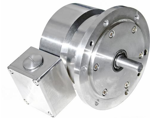
IXARCロータリーエンコーダには、磁気式と 光学式があります。アブソリュートエンコーダの精度は0.02°、分解能は16ビット、インクリメンタルエンコーダのPPRは16,384を実現しています。
