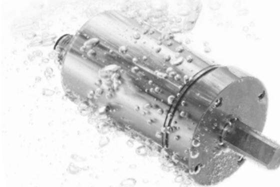
IXARC Drehgeber bieten einen Schutzgrad von bis zu IP69K. Das Design aus Edelstahlgehäuse und Flansch schützt den Drehgeber vor Korrosion durch Gase und Staub. Die Schwerlastversionen der Drehgeber können Wellenbelastungen von bis zu 300 N aushalten und bieten eine Stoßfestigkeit von bis zu 300 g.
