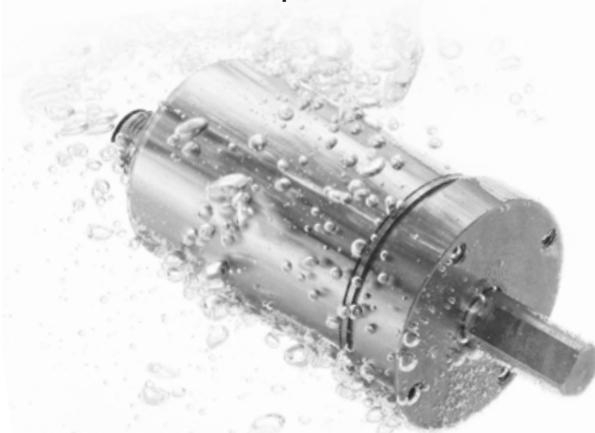
Os encoders rotativos da família IXARC podem fornecer até a classe de proteção IP69K. O design de carcaça de aço inoxidável e flange está disponível, o que pode proteger o encoder contra a corrosão de gás e poeira. Os encoders heavy duty podem suportar cargas de eixo de até 300N e oferecem uma resistência a choques de até 300g
