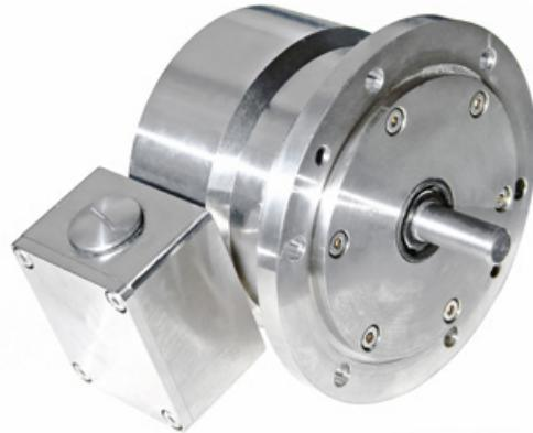
Os encoders rotativos da família IXARC podem ser encoders ópticos ou magnéticos. A precisão dos encoders absolutos pode atingir 0,02° e a resolução pode chegar a 16 bits. O PPR dos encoders incrementais pode atingir 16.384 pulsos por resolução.
