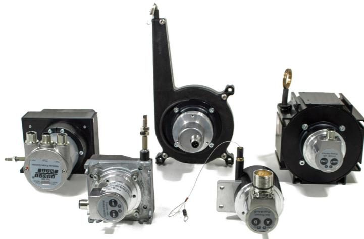
ドローワイヤセンサは、ケーブルプレセンサとも呼ばれ、エンコーダを使用して直線位置を測定するように設計されており、高精度なセンシングが可能です。ドローワイヤに接続されたエンコーダは、引き出されたケーブルに比例した信号を出力します。ピニオンとラックは完璧なアライメントとはんだ付けが必要ですが、ドローワイヤセンサは多様なインターフェースオプションにより、簡単に設置できるシステムを提供します。強力なUBIFASTコンフィギュレーションツールにより、お客様は希望する測定範囲を選択した後に、必要な分解能を定義することができます。そのため、リニア変位を伴うあらゆるタイプのアプリケーションに対応できます。
