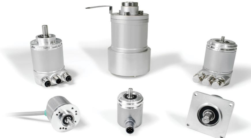
アブソリュートロータリエンコーダは、電源を入れた瞬間からユニークな位置値を提供することができます。システムの電源が切れている間に発生した動きも、エンコーダの電源を入れ直せば正確な位置に変換されます。もう一つの利点は、その豊富なバリエーションです。アブソリュートエンコーダは、シングルターン、マルチターン、異なる分解能、通信インターフェースなどを選択することができます。またユーザーは何千もの機械的および接続構成から、ニーズに合わせて選択することができます。
