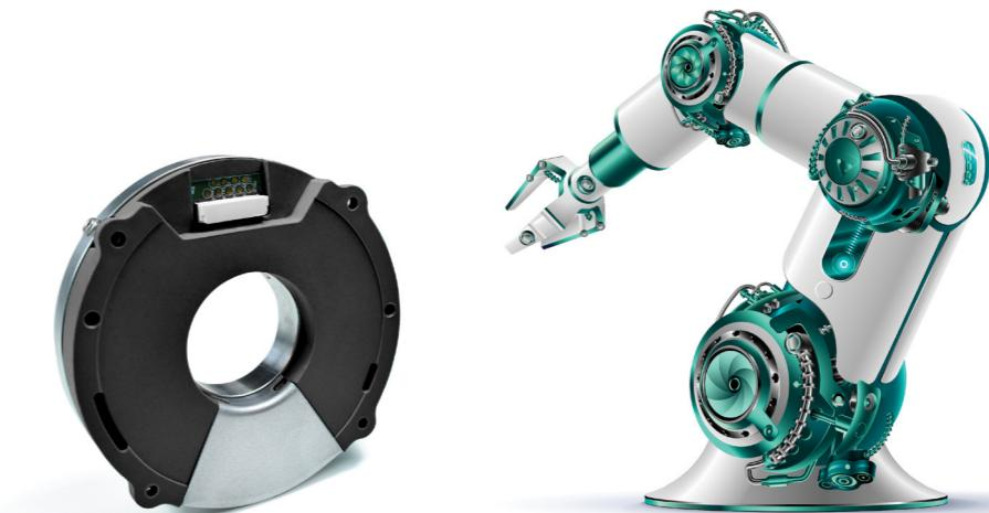
POSITALの中空軸キットエンコーダは、バッテリーやギアシステムを必要とせず、広い多回転域を提供します。厚さ18mmのスリムなデザインです。最大19ビットの分解能を持ち、中空軸モータやロボットに組み込むことができるよう設計されています。ロボットシステムでは、中空軸の設計により、ケーブルや圧縮空気をロボットアームの内部に配線することができます。シングルターンシステムは静電容量方式を採用し、POSITALの実績あるWiegand 技術との組み合わせで実現されています。このキットエンコーダをモーターに組み付ける際に、特別な工具や高価な設備は必要ありません。
