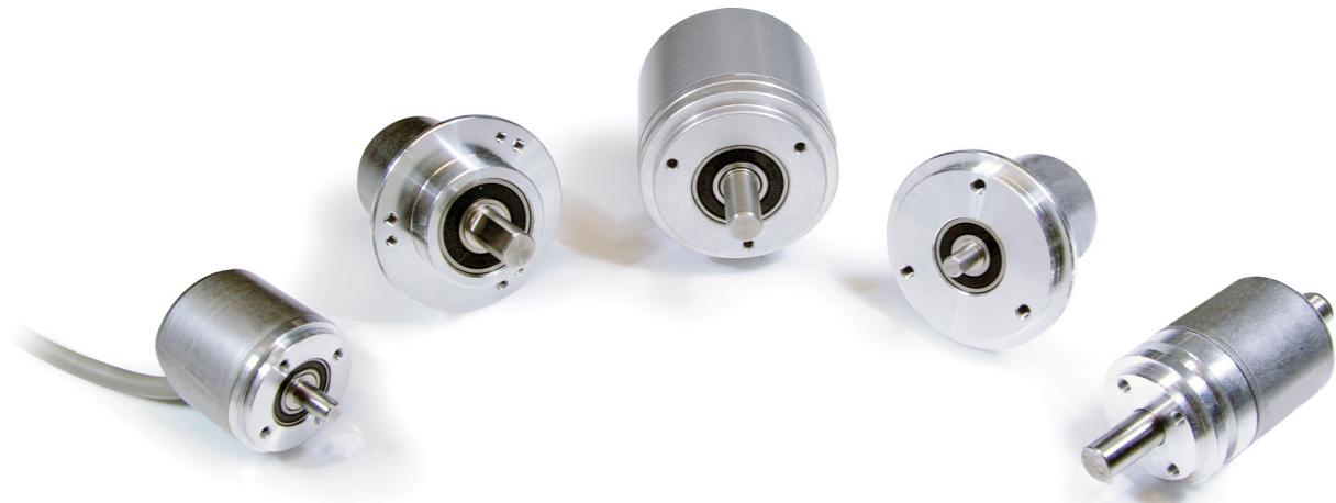
インクリメンタルロータリエンコーダは、シャフトが一定角度回転するたびに、出力信号を発します。PPRとも呼ばれる1回転あたりの信号(パルス)数は、デバイスの分解能を定義します。インクリメンタルエンコーダは、アブソリュートエンコーダと比較して内部部品が非常にシンプルです。このため正確な位置決めを行いながら、シンプルでコスト効率の高いソリューションを求める多くのアプリケーションに適しています。A, B, Z, などの一般的な構成と、HTL(プッシュプル)またはTTL(RS422)として利用できる反転信号があります。POSITAL磁気式エンコーダは、UBIFASTコンフィギュレーションツールですべて設定することができ、在庫レベルの低減に役立ちます。
