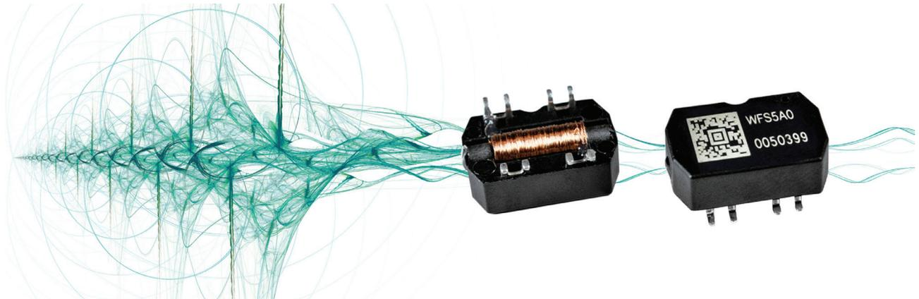
POSITAL的Wiegand能量采集系统是所有POSITAL多圈编码器的核心。它不需要备用电池和多圈齿轮组。在任何转速下,即使是最慢的转速,韦根系统每转一圈都会产生强大的电压脉冲。即使外部电源不可用,这些脉冲也能为电子设备提供足够的电力。这对于维护期间经常会发生断电的阀门和执行机构行业来说是一个非常宝贵的特性。
